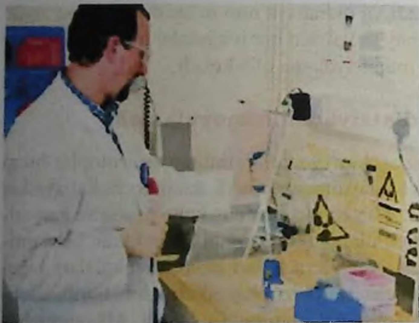
3.2-rasm. Radioizotoplar bilan ishlagan odam himoyalovchi kiyim va qo'lqop kiyib olib, qalqon – ekran ortida ishlaydi.
