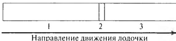
Рис. 10.4. Схема кристаллизации вещества при зонной плавке: 1 — исходный препарат; 2 — расплав; 3 — очищенный продукт
