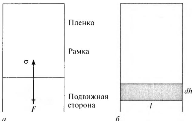
Рис. 21.2 Иллюстрация силового определения поверхностного натяжения
