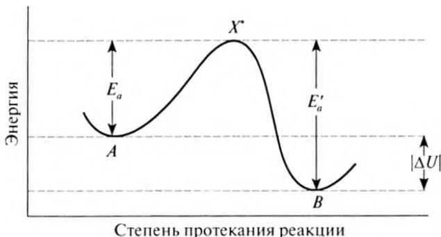
Рис. 19.8. Схематическое изображение процесса активации для элементарной реакции
