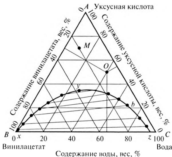
Рис. 9.5. Фазовая диаграмма трехкомпонентной системы
