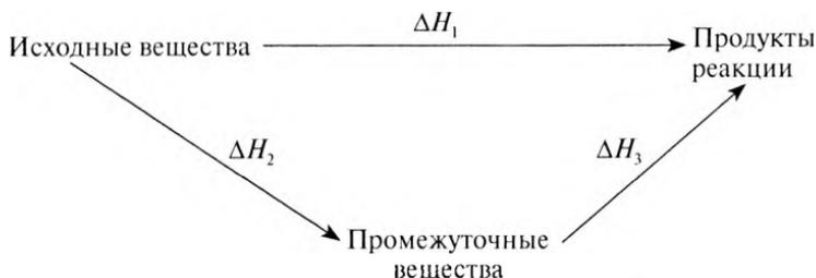
Рис. 2.2. Закон Гесса для реакции, которая может протекать двумя путями
