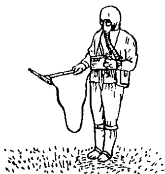
20-rasm. Zararlangan joylardagi gamma radiatsiya darajasini DP-5V asbobi yordamida aniqlash.
