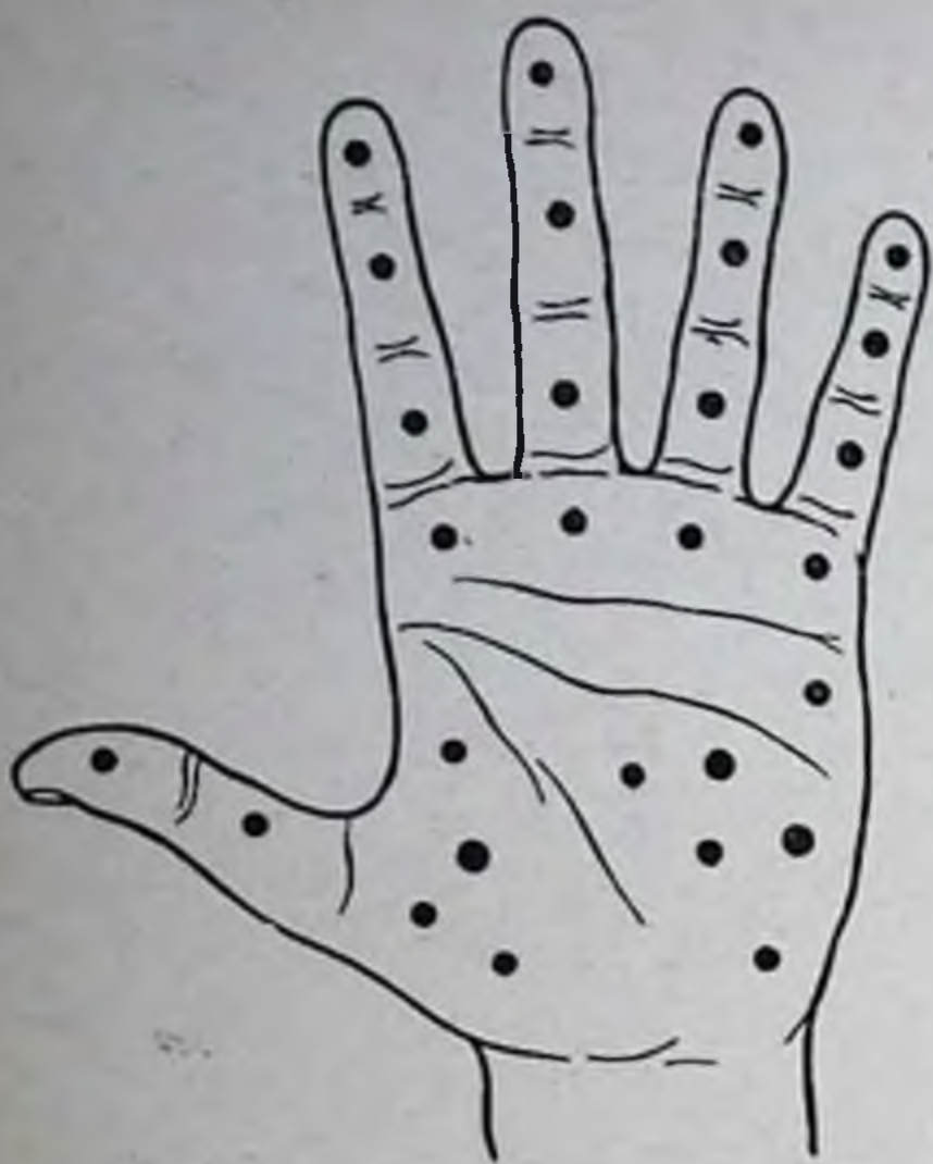
Рис. 14. Расположение тензодатчиков на поверхности ладони по способу М. М. Сперанского.
