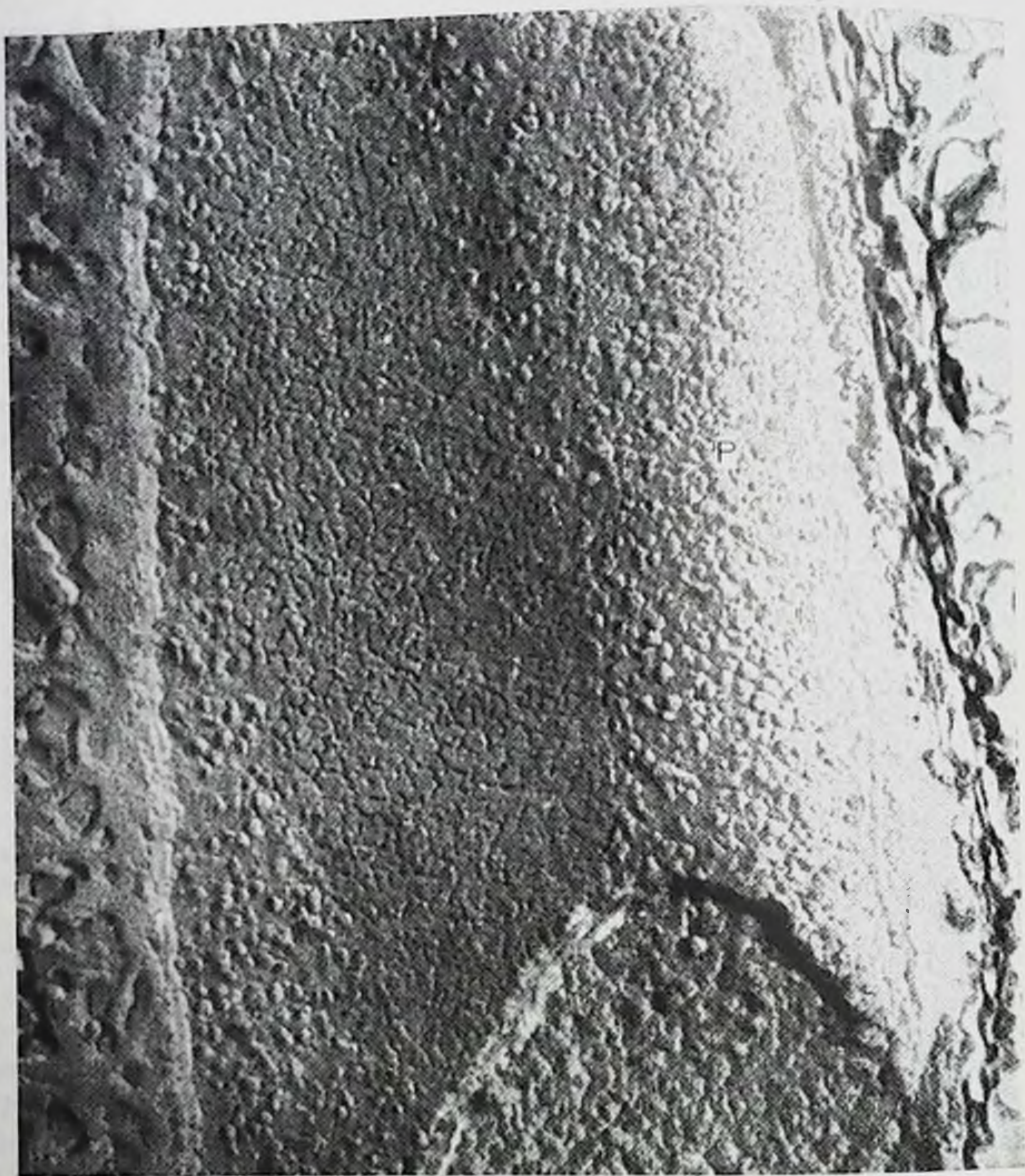
Рис. 101. То же, что на рис. 100, но репликация идет при -150^{\circ}\text{C} после травления в течение 5 мин. Ув. 160 000.
