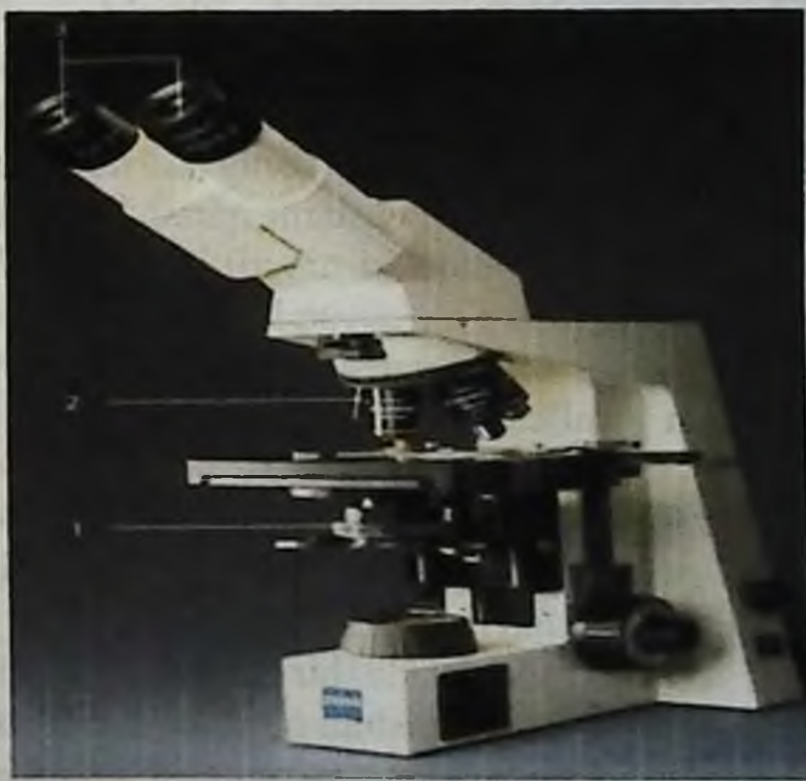
1-rasm. Zamonaviy yorug'lik mikroskopi (Karl Zeiss). 1-kondensator; 2-linzalar; 3 - ko'zoynak.
