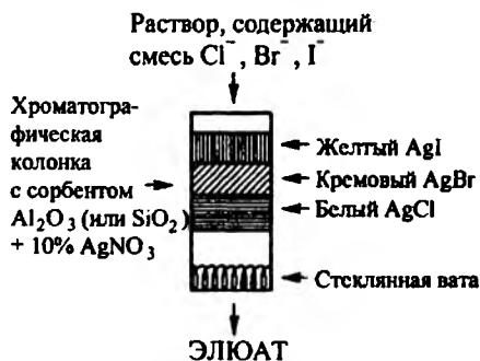
Рис. 10.7. Схема разделения ионов \text{Cl}^- , \text{Br}^- и \text{I}^- в хроматографической колонке методом осадочной хроматографии
