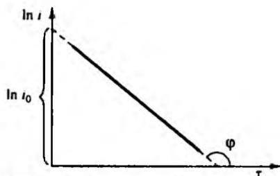
Рис. 10.9. Зависимость  $\ln i$  от времени электролиза  $\tau$  в прямой потенциостатической кулонометрии
