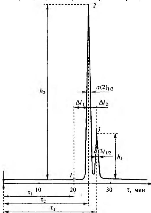
Рис. 9.9. ГЖ-хроматограмма смеси нео-dl-ментола (1), d,l-ментола (2) и изо-d,l-ментола (3). Пик растворителя (этанола), а также высота и полуширина пика  $l$  не указаны
