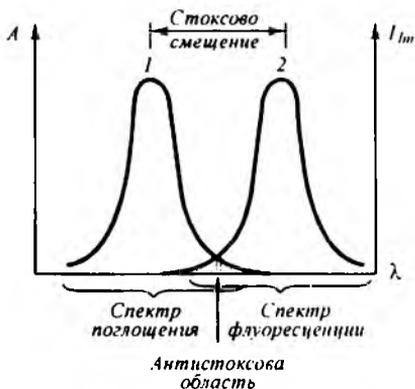
**Рис. 8.21.** Спектр поглощения (1) и спектр флуоресценции (2).  $A$  — светопоглощение,  $I_{lm}$  — интенсивность люминесценции,  $\lambda$  — длина волны
