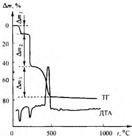
**Рис. 2.1.** Термогравиметрическая (ТГ) и термограммическая (ДТА) кривые салицилатного комплекса цинка  $Zn(НОС_6H_4COO)_2 \cdot 2H_2O$ ;  $\Delta m$ , % — потеря массы в процентах от исходной навески (100 мг) комплекса. Минимумы на кривой ДТА соответствуют эндотермическим термоэффектам, максимум — экзотермическому термоэффекту
