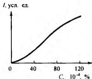
Рис. 8.24. Зависимость интенсивности  $I$  линии излучения в спектре калия (в условных единицах — показаниях по шкале прибора) от содержания калия в растворе
