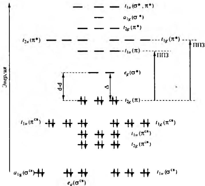
Рис. 8.9. Схема заселенности электронами молекулярных орбиталей ферроцианид-иона  $[\text{Fe}(\text{CN})_6]^{4-}$  в основном электронном состоянии (указаны не все высоколежащие вакантные уровни); ППЗ — переходы с переносом заряда от металла к лигандам
