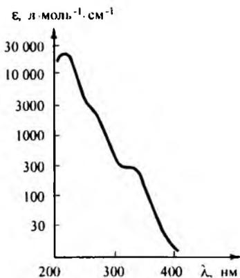
Рис. 8.10. Спектр поглощения водного раствора ферроцианида калия  $\text{K}_4[\text{Fe}(\text{CN})_6]$
