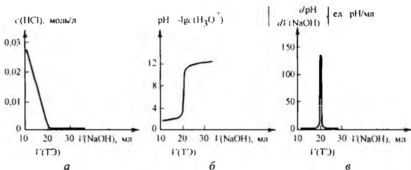
**Рис. 3.1.** Различные типы расчетных кривых титрования 20 мл 0,1 моль/л раствора HCl эквимолярным раствором NaOH:
