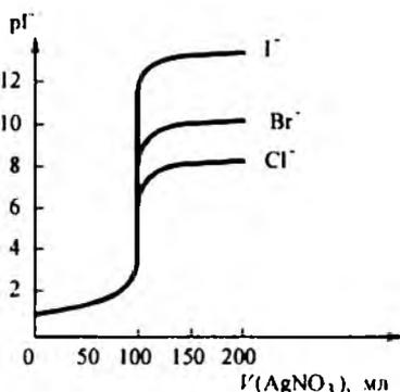
Рис. 6.2. Сравнение кривых осадительного титрования 0,1 моль/л растворов  $KCl$ ,  $KBr$  и  $KI$  стандартным 0,1 моль/л раствором нитрата серебра
