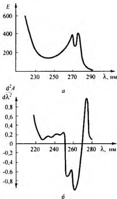
Рис. 8.15. Спектр поглощения (а) и спектральная кривая второй производной (б), построенная с интервалом  $\Delta\lambda = 4$  нм, раствора геофиллина
