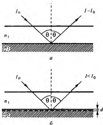
Рис. 8.25. Схема внутреннего отражения ( $n_2 < n_1$ ):
