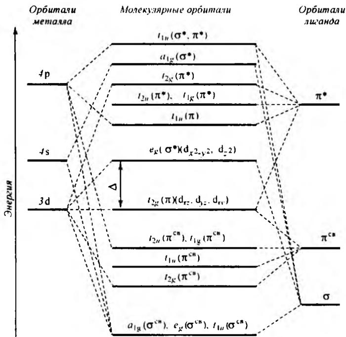
**Рис. 8.8.** Схема образования уровней энергии — молекулярных орбиталей октаэдрических гексацианокомплексов  $3d$ -металлов ( $\Delta$  — величина расщепления в поле лигандов)
