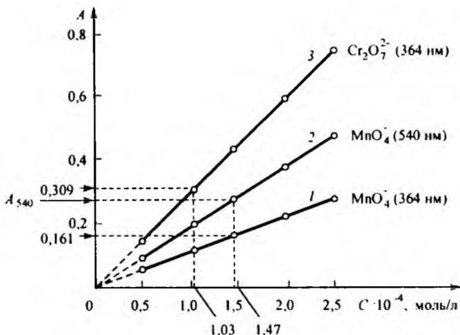
**Рис. 8.28.** Зависимость оптической плотности  $A$  растворов, содержащих перманганат-ионы (1, 2) или дихромат-ионы (3), от их концентрации  $c$  при различных постоянных длинах волн. Оптическая плотность измерена на фотоэлектроколориметре со светофильтрами, имеющими максимальное светопропускание при 364 нм или при 540 нм;  $l = 1$  см
