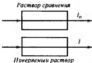
Рис. 8.2. Компенсация ослабления светового потока с использованием раствора сравнения
