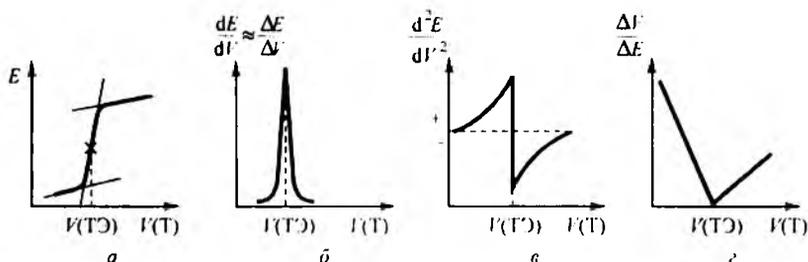
**Рис. 10.1.** Типы кривых потенциметрического титрования ( $E$  — измеряемая ЭДС,  $V(T)$  — объем прибавленного титранта,  $V(TЭ)$  — объем титранта, прибавленного в точке эквивалентности):
