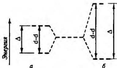
Рис. 8.6. Схема расщепления  $d$ -атомных орбиталей катиона металла в тетраэдрическом (а) и октаэдрическом (б) поле лигандов и  $d-d$ -переходы
