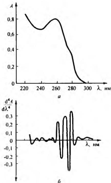
Рис. 8.17. Спектр поглощения раствора, содержащего смесь амидопирин и дибазола (а), и спектральная кривая четвертой производной (б) для того же раствора
