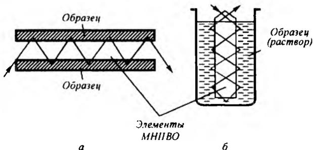
Рис. 8.26. Схематическое представление многократно нарушенного полного внутреннего отражения (МНПВО):
