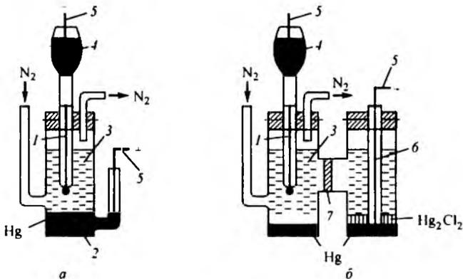
Рис. 10.3. Схема полярграфической ячейки с ртутным капающим электродом и с ртутным анодом (а) или с насыщенным каломельным электродом (б):
