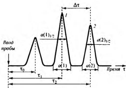
Рис. 9.2. Схематическое изображение хроматограммы в случае разделения трехкомпонентной смеси:  $\tau_0$  — время выхода несорбируемого компонента;  $\tau_1$  — время удерживания компонента 1;  $\tau_2$  — время удерживания компонента 2;  $a(1)$  и  $a(2)$  — ширина пиков компонентов 1 и 2;  $a(1)_{1/2}$  и  $a(2)_{1/2}$  — полуширина пиков компонентов 1 и 2;  $\Delta\tau$  — разделение пиков
