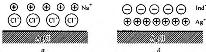
Рис. 6.3. Схематическое изображение структуры поверхности осадка  $\text{AgCl}$  до ТЭ (а) и после ТЭ (б)
