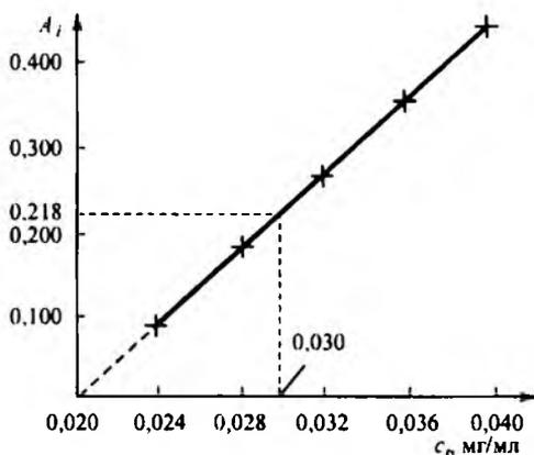
Рис. 8.30. Градуировочный график для определения содержания марганца методом дифференциальной спектрофотометрии.  $A_i$  — относительная оптическая плотность,  $c_i$  — содержание марганца в растворе, мг/мл
