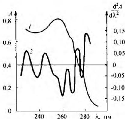
Рис. 8.16. Спектр поглощения (1) и спектральная кривая второй производной (2) раствора смеси амидопирин и дибазола
