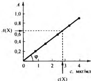
Рис. 8.27. Зависимость оптической плотности  $A$  раствора комплекса никеля с диметилглиоксимом от концентрации  $c$  никеля в растворе ( $l = 1 \text{ см}$ )
