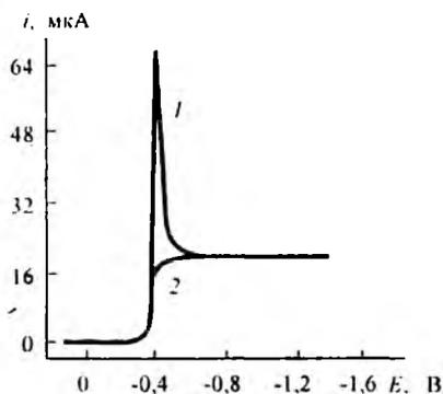
**Рис. 10.6.** Максимум на полярограмме (осцилляции не показаны) катионов свинца (1) на фоне 0,1 моль/л раствора KCl и подавление максимума (2) в присутствии натриевой соли метилового красного;  $i$  — ток,  $E$  — приложенный потенциал относительно насыщенного каломельного электрода
