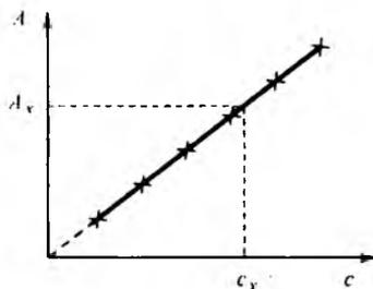
Рис. 8.12. Градуировочный график, построенный на основании фотометрических измерений
