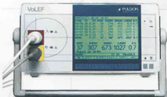
Рис. 14-7. «Pulsion VoLEF». Мониторный блок для пульмональной термодилуции со встроенной программой расчета показателей гемодинамики малого круга кровообращения.
