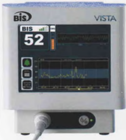
Рис. 14-11. Мониторы для регистрации биспектрального индекса (платформа «Vista») и индекса слуховых вызванных потенциалов.
