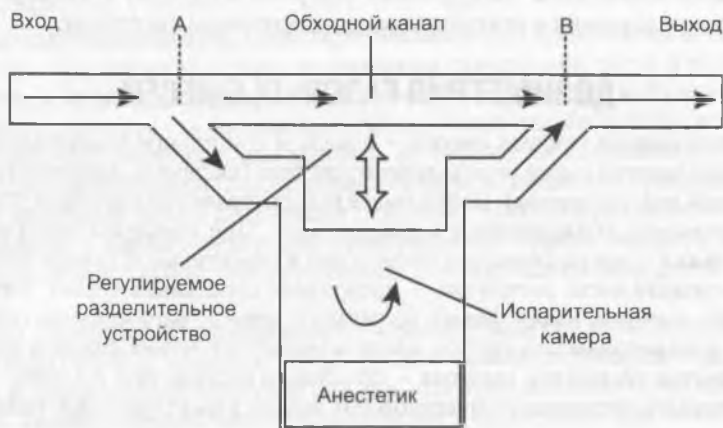
Рис. 10-2. Дыхательный газ поступает на вход испарителя в точке «А», газ разделяется на 2 потока. Один поток поступает в обходной канал, второй — направлен в испарительную камеру. Поток, поступающий в испарительную камеру, регулируется разделительным оборудованием. В испарительной камере газ насыщается парами анестетика. В точке «В» пар смешивается с потоком газа из обходного канала до заданной концентрации и поступает на выход из испарителя.
