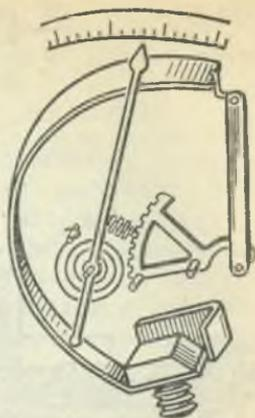
порционного величине упругой деформации манометрической трубки, через которую пропускается газ. Механизм манометра состоит из трубки, тяги, сектора, спиральной пружины, стрелки и шкалы. Разжимное кольцо закрепляет стекло циферблата в корпусе. Предельное рабочее давление отмечено на шкале красной риской. На манометрах, предназначенных для измерения давления кислорода, имеются надписи на циферблате «Кислород» и «Масло опасно».
