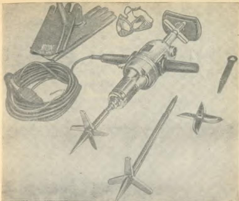
Рис. 24. Инструмент механизированный для дробления слежавшихся порошков.
