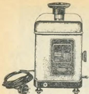
Рис. 33. Весы технические квадрантные типа ВТК.
