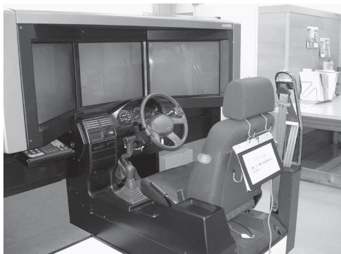
1.15 rasm. Avtomobilni qo‘lda boshqarishni mashq qiladigan trenajor.
