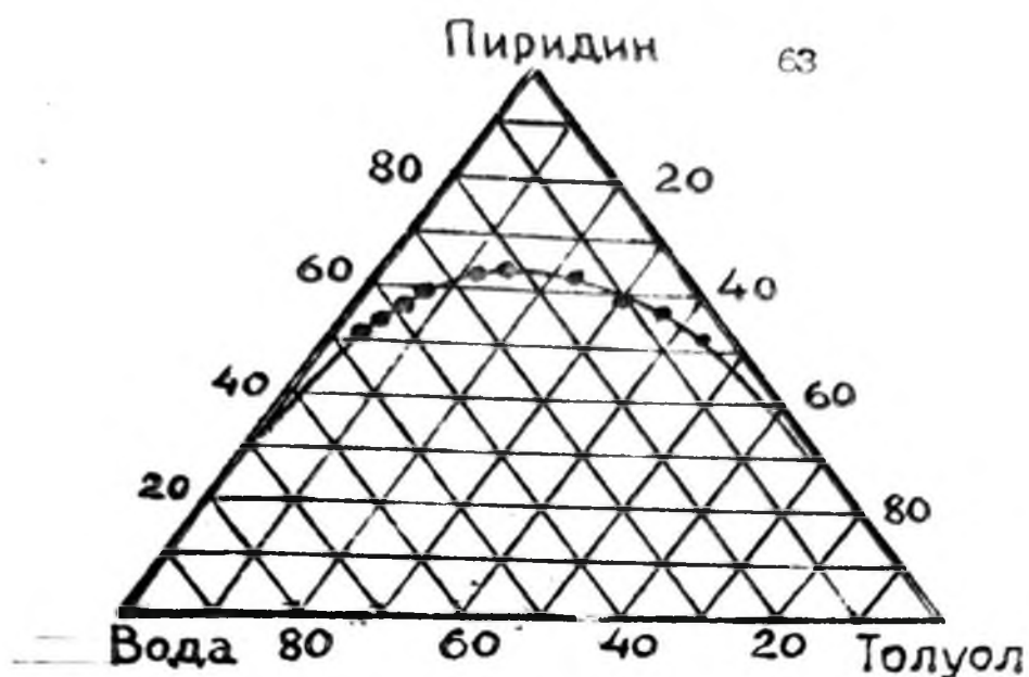
Рис. 2.1 Кривая растворимости для тройной системы толуол - вода - пиридин.
