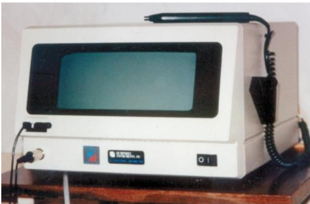
Рис. 35. Ультразвуковой А-сканер для измерения переднезаднего размера глазного яблока, глубины передней камеры, толщины хрусталика «Hurriprirey instruments inc.»
