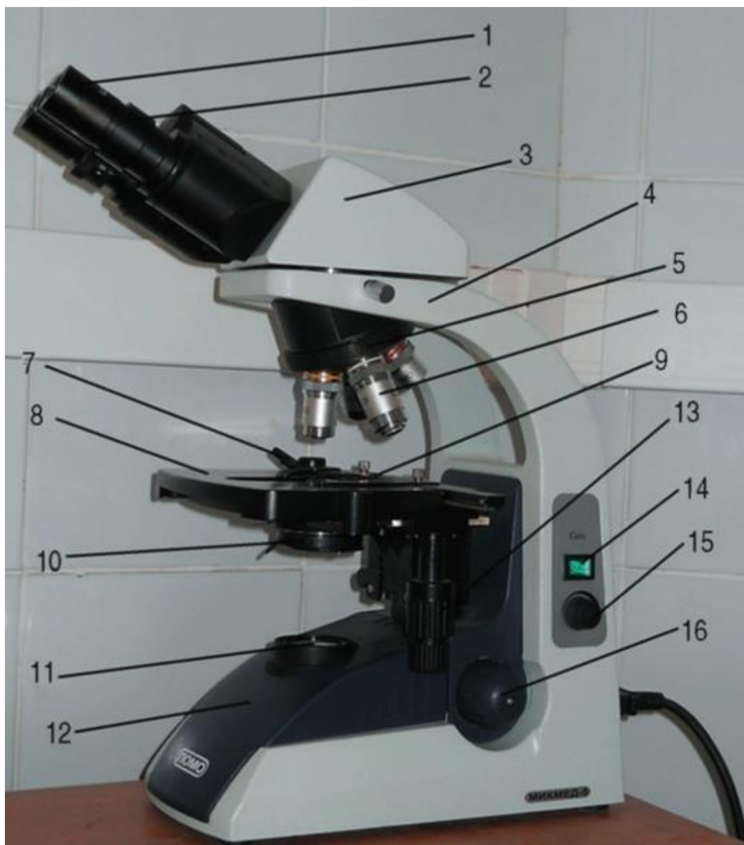
Рис. 2.14. Устройство светового микроскопа (на примере микроскопа МИК-МЕД-5): 1 - окуляр; 2 - тубус; 3 - бинокулярная насадка; 4 - штатив-тубусодержатель; 5 - револьверная насадка; 6 - набор сухих и иммерсионных объективов; 7 - зажим для закрепления предметного стекла; 8 - предметный столик; 9 - координатный столик; 10 - конденсор с ирисовой диафрагмой; 11 - осветительное устройство; 12 - основание (подставка); 13 - винт плавного перемещения предметного столика по горизонтали/вертикали; 14 - тумблер включения осветителя; 15 - регулировка яркости осветителя; 16 - винт точной микрометрической настройки (микровинт). Винт грубой макрометрической настройки (макрвинт) расположен на противоположной стороне корпуса микроскопа
