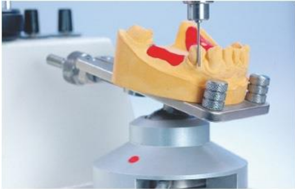
Рис. Выбор наклона рабочей модели в параллелометре
