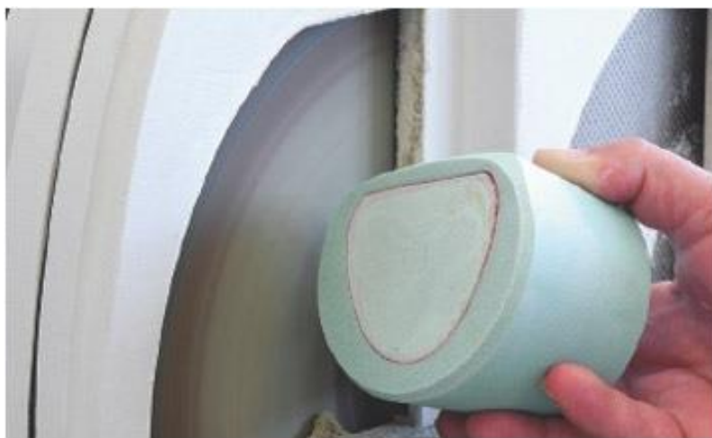
Рис. Придание необходимой формы огнеупорной опоке перед заливкой металла
