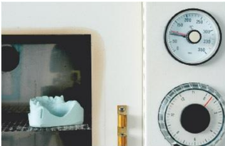
Рис. Высушивание керамической огнеупорной модели
