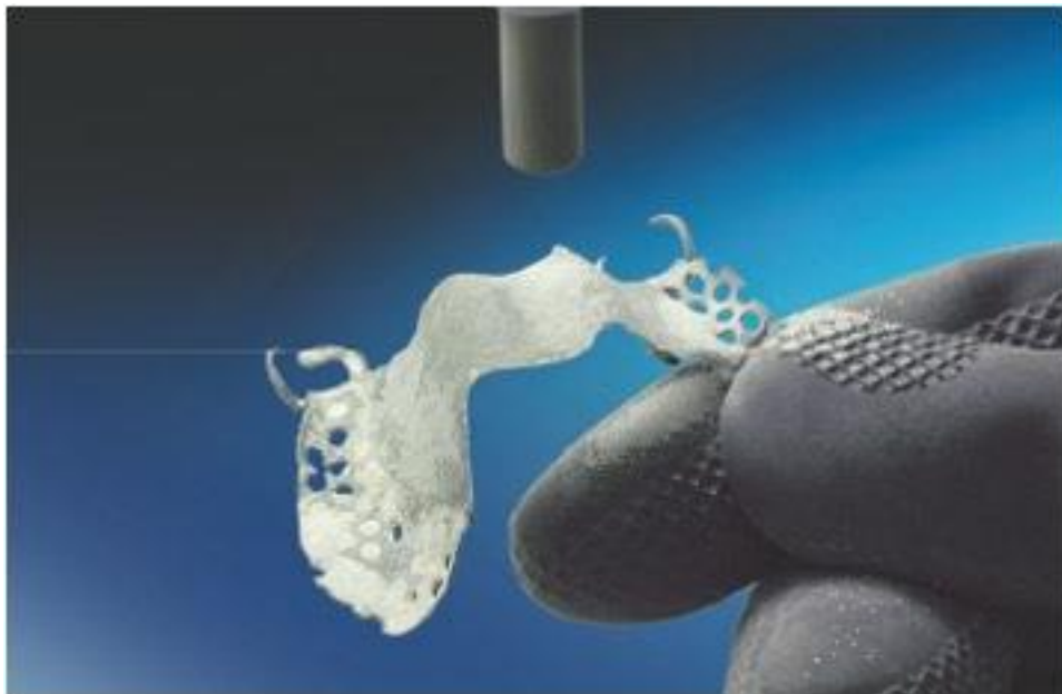
Рис. Пескоструйная обработка каркаса бюгельного протеза
