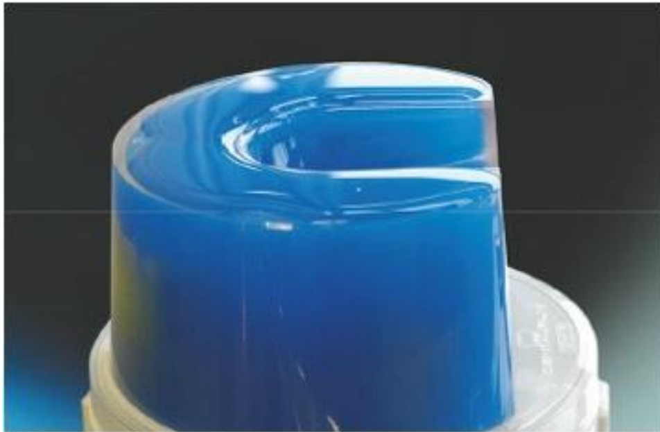
Рис. Полное заполнение кюветы дублирующей массой
