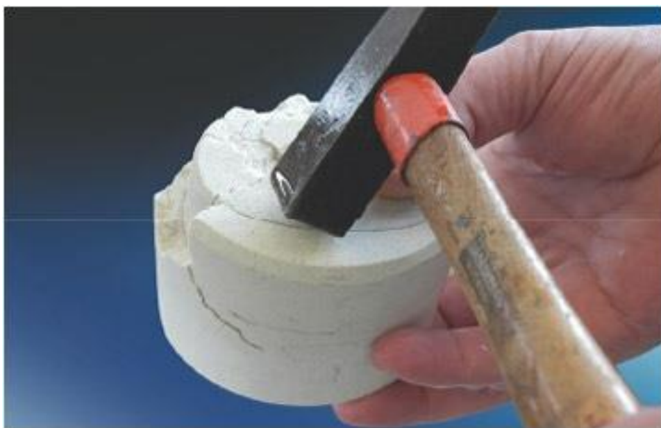
Рис. Освобождение металлического каркаса от формировочной массы
