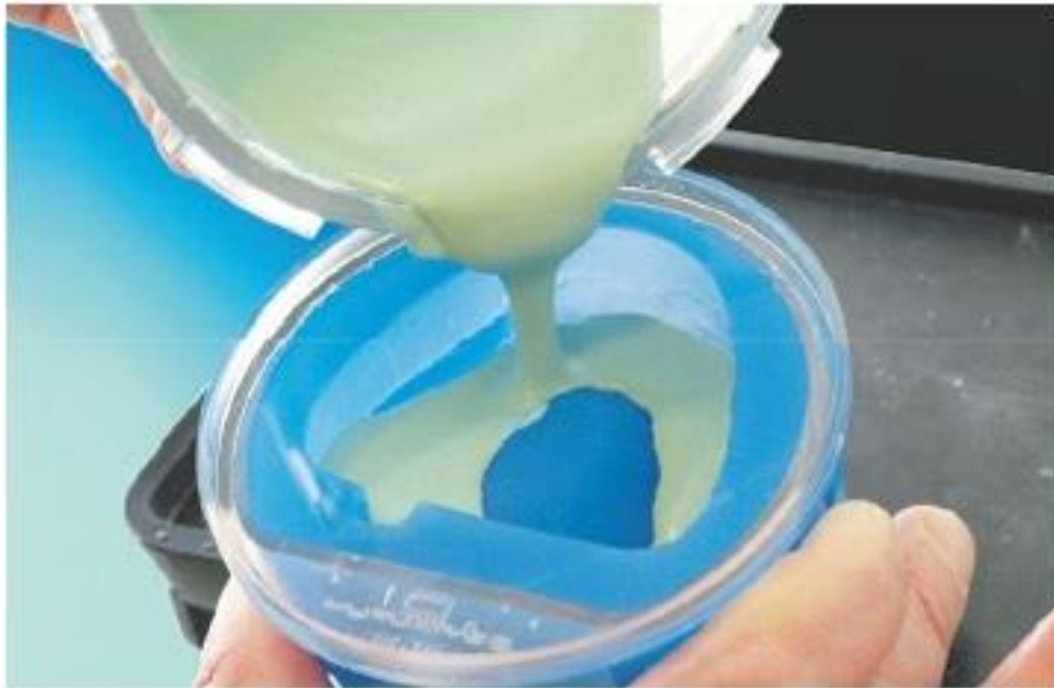
Рис. Заполнение дублирующей формы керамической огнеупорной массой
