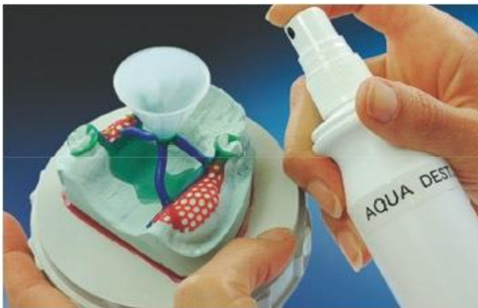
Рис. Подготовка восковой композиции на керамической огнеупорной модели к изготовлению литейной формы
